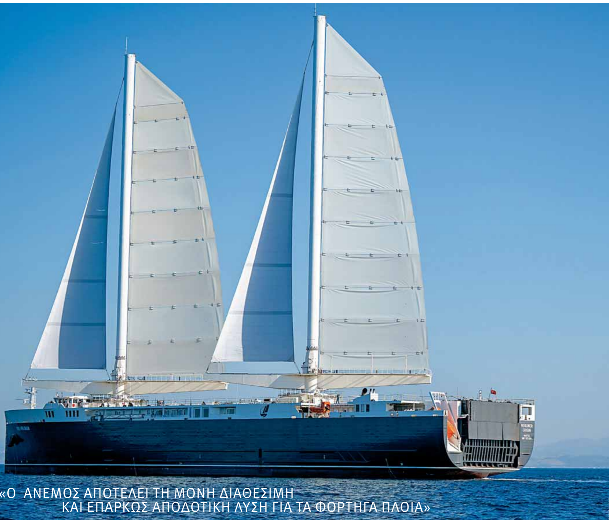
Φωτογραφία από τα δοκιμαστικά, τον περασμένο Αύγουστο. Οι ιστοί διπλώνουν ώστε το πλοίο να περνάει ανεμπόδιστα κάτω από τις γέφυρες
